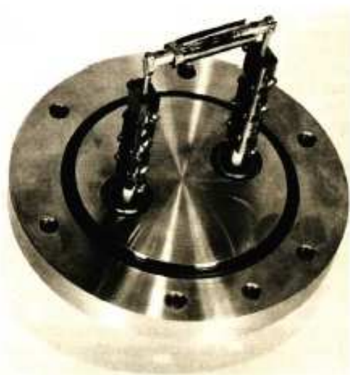
Figure : source d'ions à ionisation de surface développée à Orsay pour ioniser les métaux alcalins et utilisés au CERN dans les années 1960[22]
